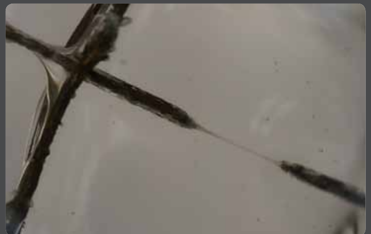
Abb. 12 Detail des zerstörten Messinggitters mit feinen „Luftkanälen“
