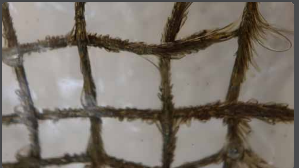
Abb. 15 Detail des zerstörten Messinggitters mit Messingdrähten in Gasumhüllung
