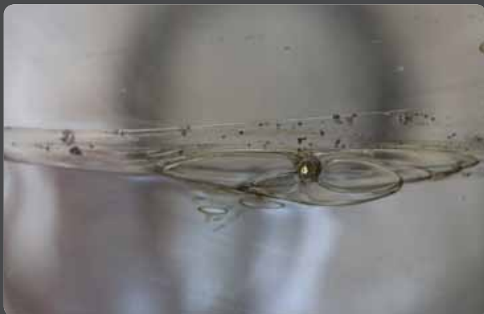
Abb. 09 Detail des zerstörten Messinggitters mit Messingkügelchen
