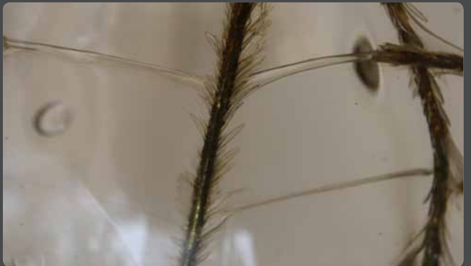
Abb. 14 Detail des zerstörten Messinggitters mit feinen „Luftkanälen“
