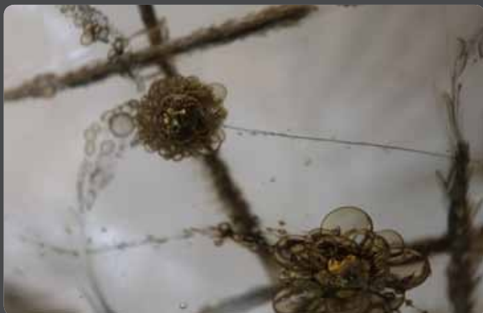
Abb. 10 Detail des zerstörten Messinggitters mit Messingkügelchen
