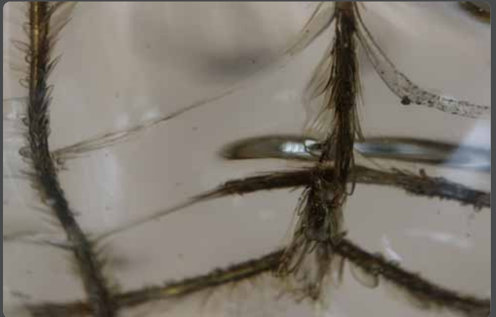
Abb. 13 Detail des zerstörten Messinggitters mit feinen „Luftkanälen“
