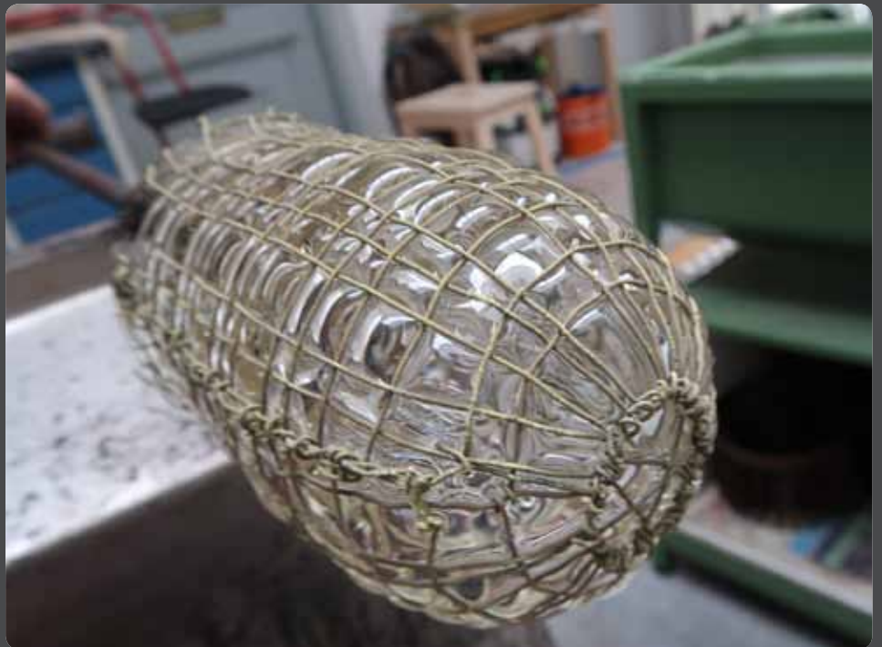
Abb. 03 Klarglas-Glasposten, eingeblassen in einen Messing-Drahtgitterkorb
