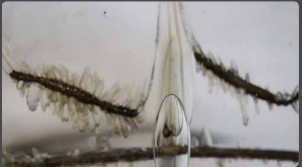
Abb. 16 Detail des zerstörten Messinggitters mit Messingdrähten in Gasumhüllung
