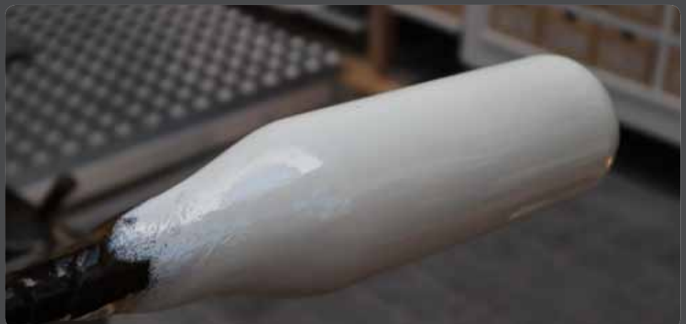
Abbildung 4: Weiß beschichteter Glasposten, in Form und Größe an den zu verwendenden Drahtgitterkorb angepasst
