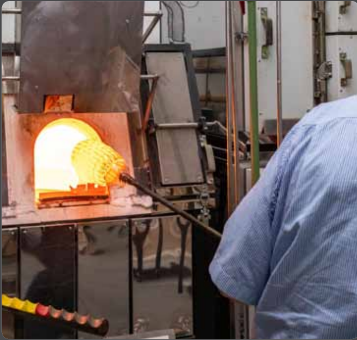
Abbildung 12: Überstechen des Glaspostens
