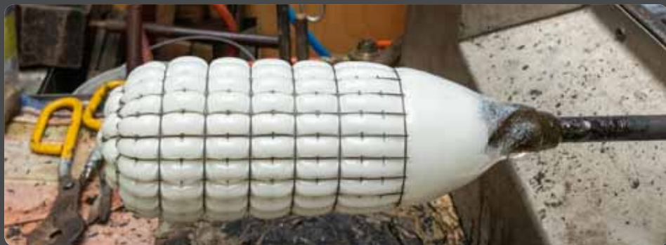
Abbildung 8: Glasposten mit stark ausgeprägten Noppen
