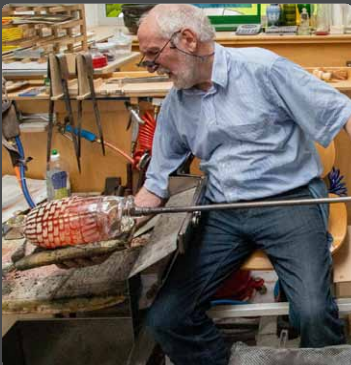
Abbildung 14: Weiteres Ausblasen des Glaspostens
