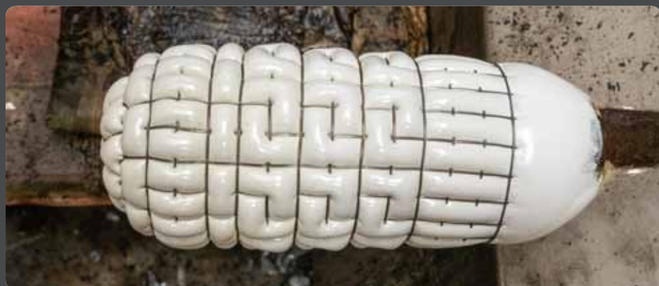
Abbildung 9: Glasposten mit variierter Wabenstruktur
