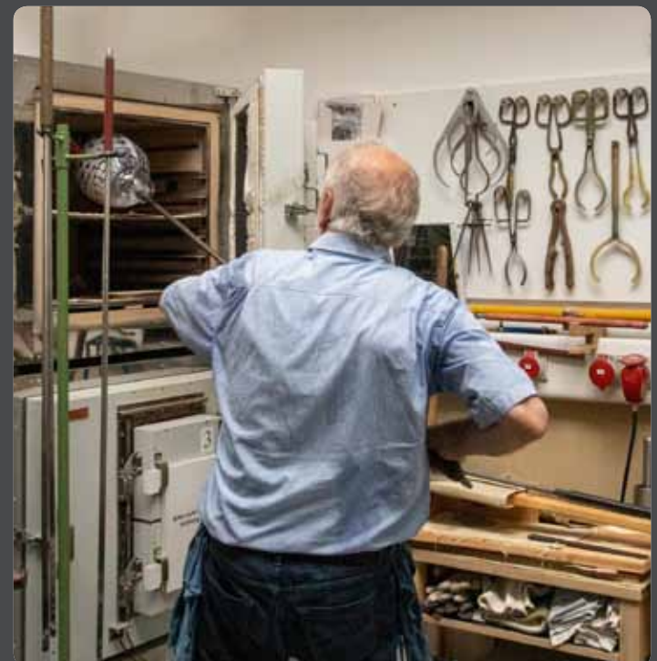
Abbildung 15: Eintragen des Wabenobjekts in den Kühllofen
