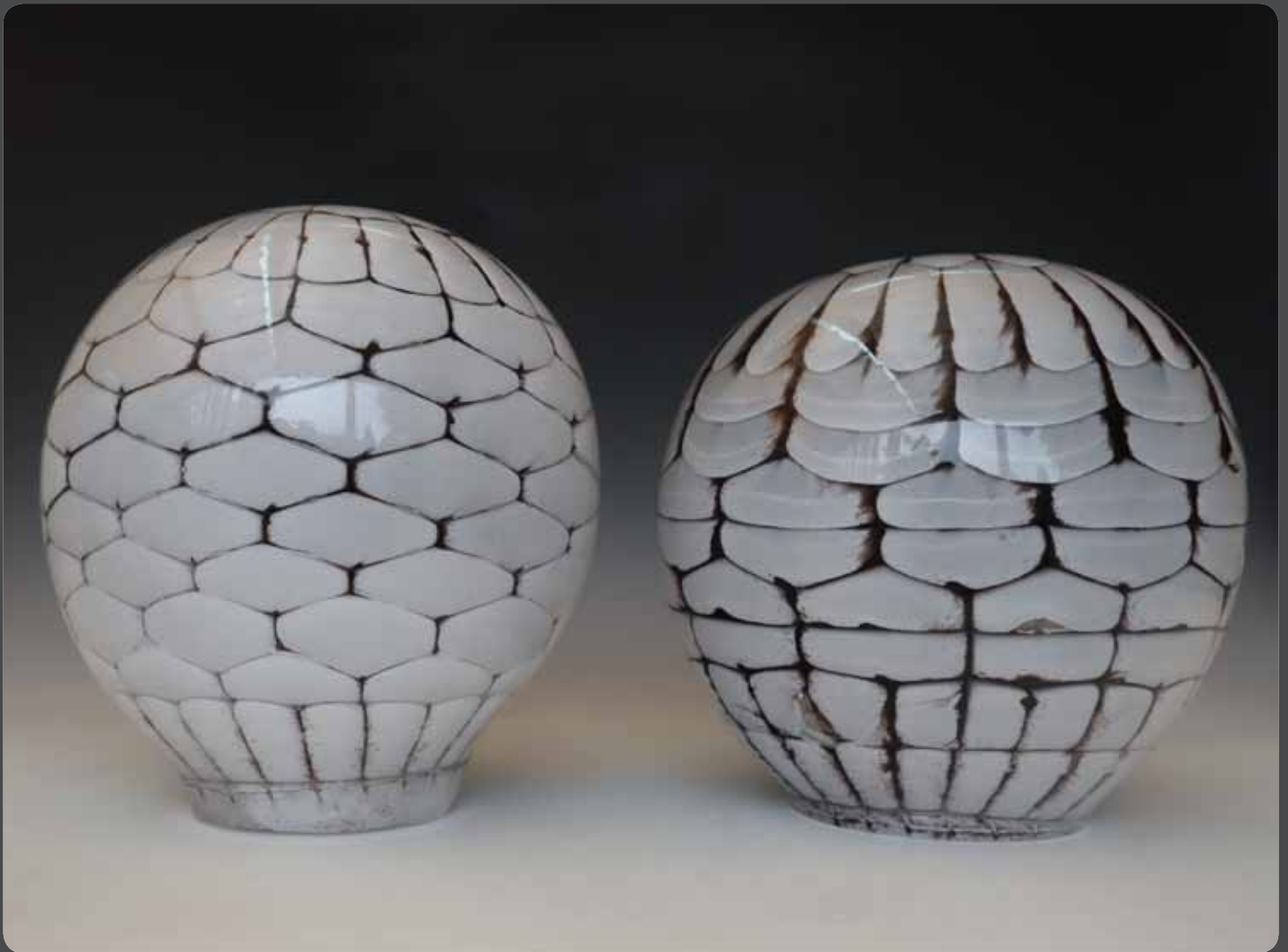
Abbildung 20:Gegenüberstellung der gerahmten Waben nach Verfahren 1 und 2
