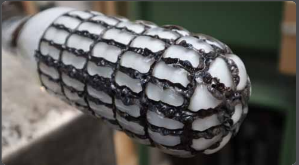
Abbildung 5: Glasposten mit stark beschichtetem Gitterkorb
