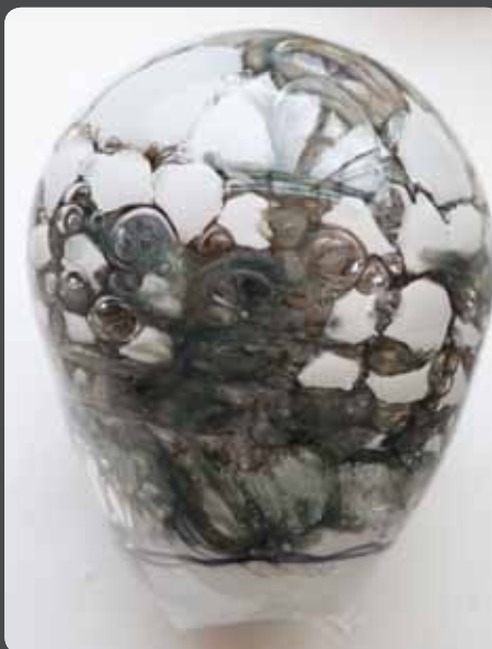
Abbildung 2: Glasobjekt mit unkontrollierter Blasenbildung nach dem Einblasen durch den beschichteten Drahtgitterkorb
