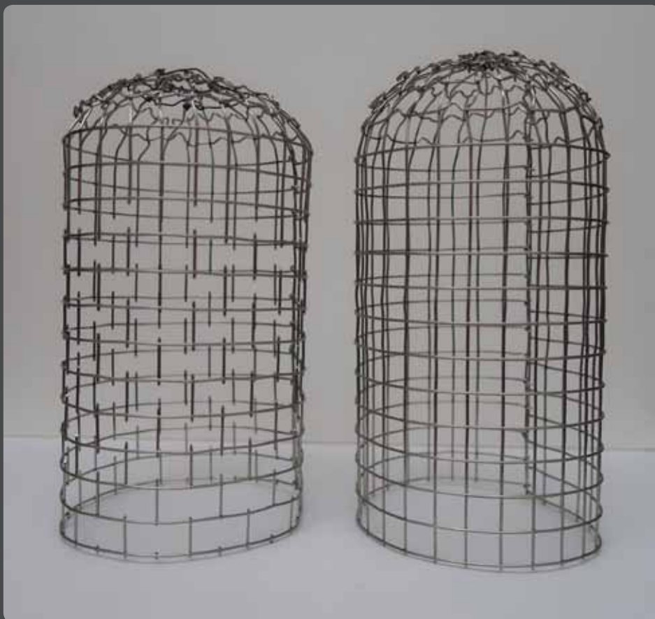
Abb. 03: Drahtgitter mit gleichen und unterschiedlichen Maschenweiten
