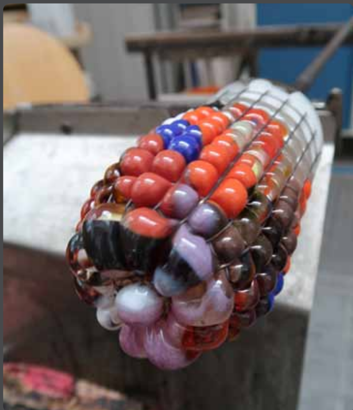
Abb. 04 Glasposten mit Drahtkorb gleicher Maschenweite
