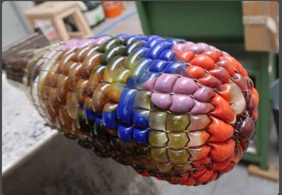
Abb. 06: Glasposten mit Drahtkorb unterschiedlicher Maschenweite
