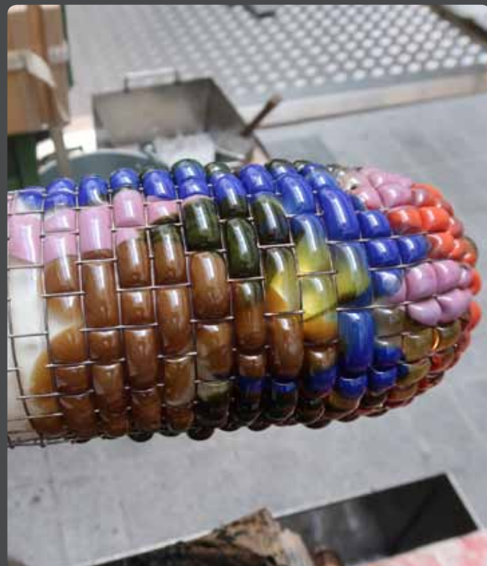
Abb. 05: Glasposten mit Drahtkorb unterschiedlicher Maschenweite.
