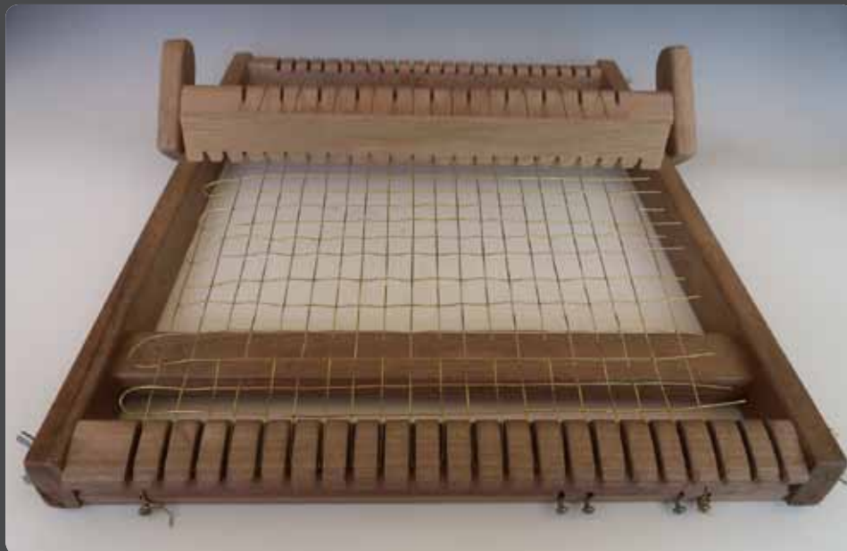
Abb. 04: Vorrichtung 2 zum Drahtgitterweben, nach Vorbild „Schulwebrahmen“
