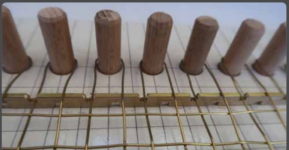
Abb. 03: Detail der Vorrichtung 1 mit Doppelkamm zum Anheben und Absenken der Kett-Drähte
