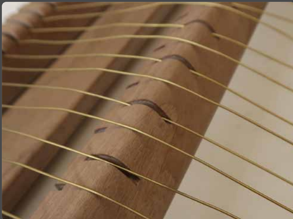
Abb. 09: Drehbalken, Detailansicht der angehobenen und abgesenkten KettDrähte
