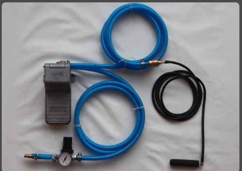
Abb. 10: Darstellung aller Elemente der Pneumatik-Glasmacherbank
